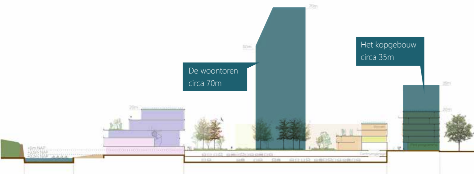
Indicatieve doorsnede van de Citadelpoort
